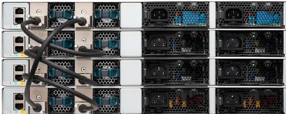
Рисунок 4. Коммутаторы серии ДатаРу КС К9200 в стеке
