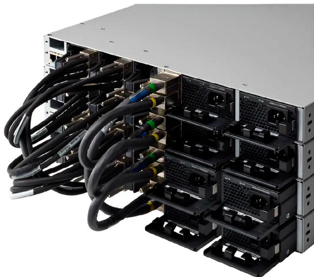
Рисунок 7. Коммутаторы серии ДатаПу КС К9300 в стеке с поддержкой технологии «Стеклауэр»
