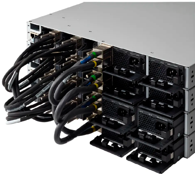
Рисунок 7. Коммутаторы серии ДатаПу КС К9300 в стеке с поддержкой технологии «Стеклауэр»
