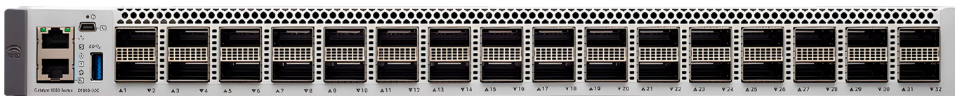
Рисунок 3. Арт. DR-KC-C9500-32C: высокопроизводительный коммутатор серии ДатаРy КС К9500 с 32 портами 100 Gigabit Ethernet
